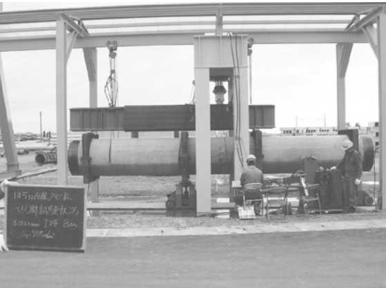
φ1000mm (Ⅰ種) せん断実験の全景
